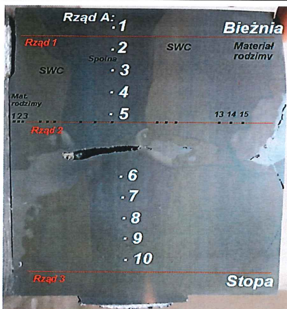
Rys.2 Rozmieszczenie punktów do pomiaru twardości. Próbka 1/2/16-R340GHT
