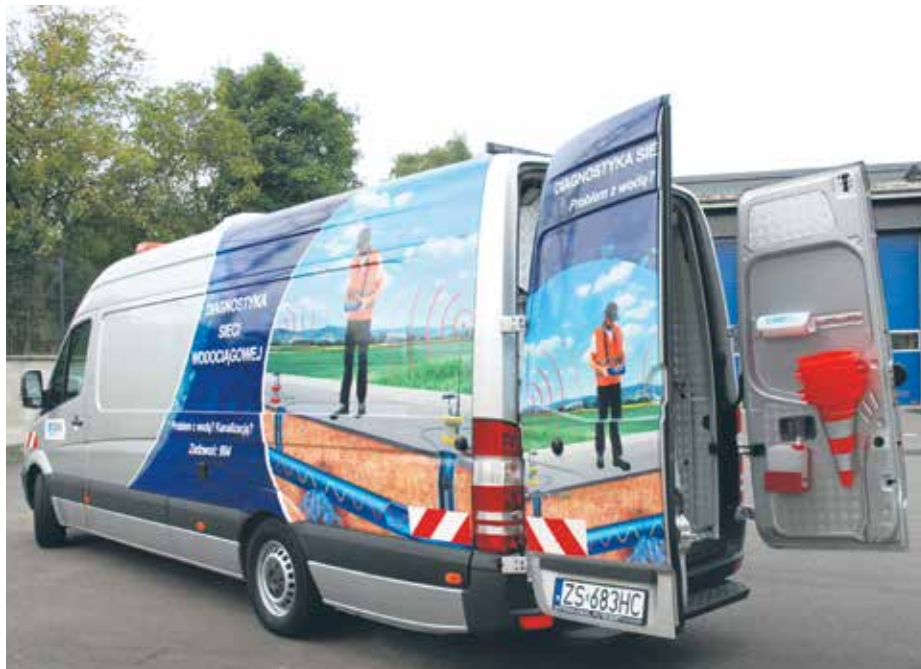
Nowy samochód do badania sieci wodociągowej i precyzyjnego lokalizowania awarii.
