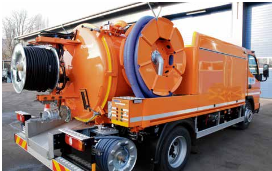
Jeden z nowych pojazdów do czyszczenia sieci kanalizacyjnej.
